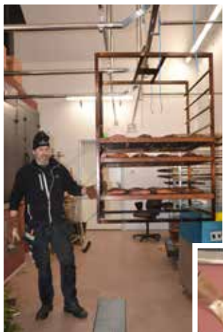
Inga tunga lyft i den nya anläggningen. Fisken på sin ställning till rökeriet går via takräls, visar Magnus.
